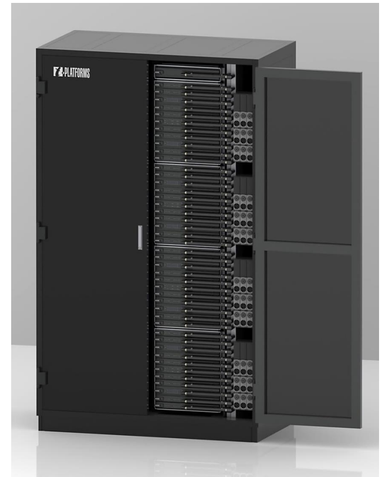
Шкаф A-Class с 4(8) блоками узлов и коммутаторов, по 32 узла в каждом
