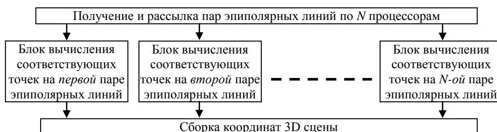
Рис. 2. Схема алгоритма с декомпозицией по эпиполярным линиям
