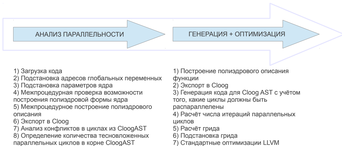
Рис. 2. Этапы генерации CUDA-ядер для параллельных циклов компилятором KernelGen. Оптимизация происходит сразу для всего SCoP, генерация – для каждой функции в отдельности
