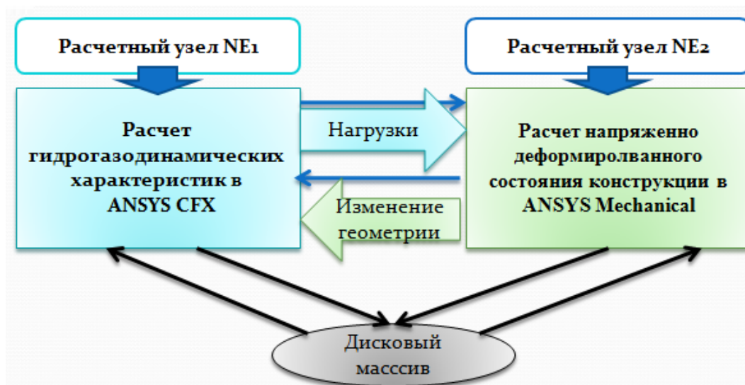
Рис. 2. Схема проведения вычислительного эксперимента на кластере
