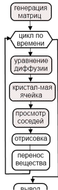
Рис. 1. Схема модулей алгоритма программы
