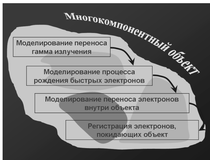
Рис. 1. Моделирование радиационной эмиссии электронов.
