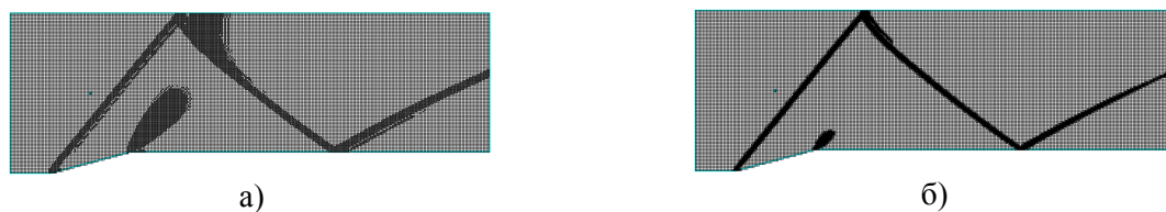
Рис. 8. Расчетная сетка при адаптации по градиенту давления первым а) и вторым б) уровнем
