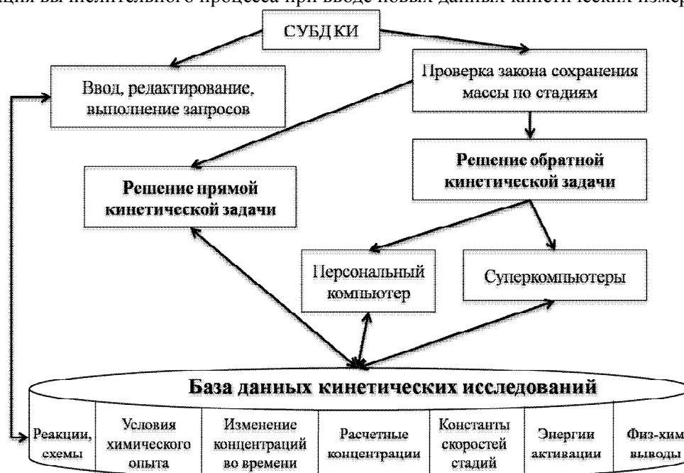
Рис. 3. Система управления базой данных кинетических исследований
