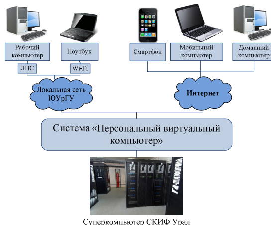
Рис. 1. Принцип работы системы «Персональный виртуальный компьютер».
