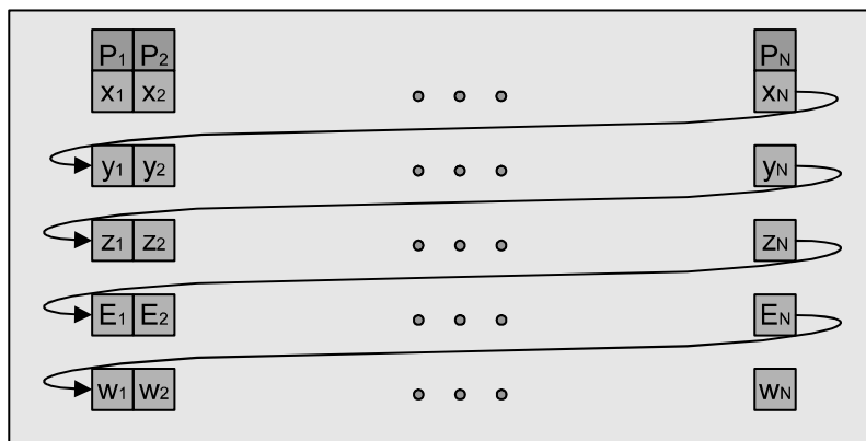
Рис. 2 - Оптимальная для выполнения на GPU структура хранения параметров электронов
