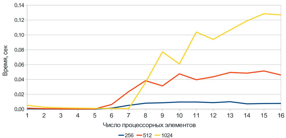
**Рис. 6.** Времена синхронизации для тестовых расчётов  $256 \times 256 \times 32$ ,  $512 \times 512 \times 32$ ,  $1024 \times 1024 \times 32$  на сервере IBM QS22
