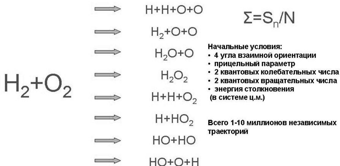
Рис.1 Исследование траекторных расчетов сечений химических реакций (кислород + водород). Время расчета одной траектории от долей минуты до нескольких часов, общее время расчета – до нескольких лет работы единичного CPU
