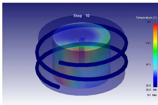
Рис.3. Распределение температуры в заготовке
