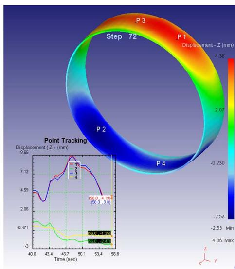
Рис.4. График смещения выбранных точек по оси Z
