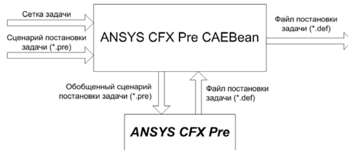
Рис. 6. Схема взаимодействия компонентного CAEBean и ANSYS CFX Pre
