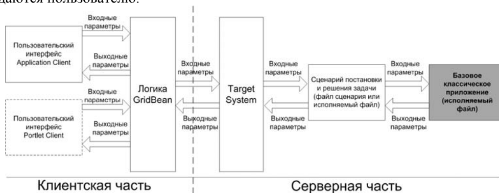
Рис. 2. Схема взаимодействия элементов клиентской и серверной частей архитектуры GridBeans
